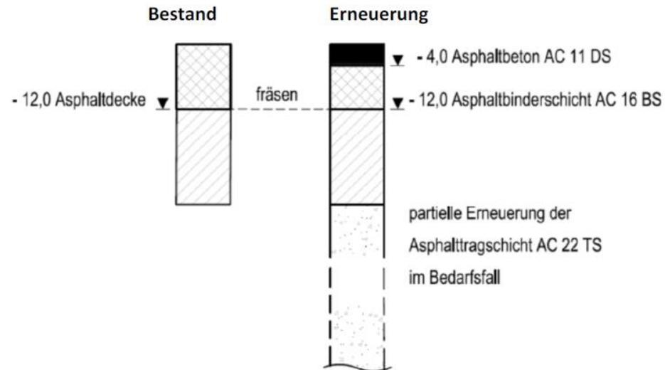
Erneuerung der Asphaltdeck- und Asphaltbinderschicht. Der Aufbau erfolgt in der Belastungsklasse Bk 10 im Tiefenbau, partielle Erneuerung der Asphalttragschicht in Teilbereichen.
